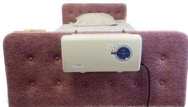
**i** Si cela s'avère impossible le suspendre au châssis en veillant à ce qu'il ne provoque pas de vibration MAIS ne le déposez JAMAIS à même le sol.
